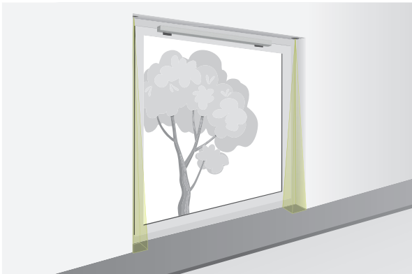
Abb 4: Schließkantensicherung an automatischen Fenstern
