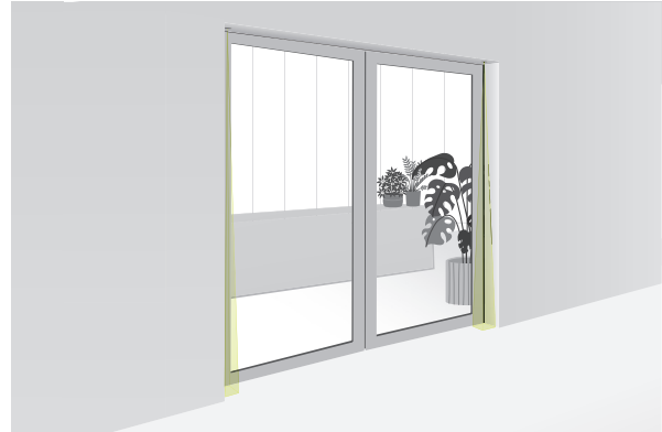
Abb 3: Absicherung an Schiebetüren
